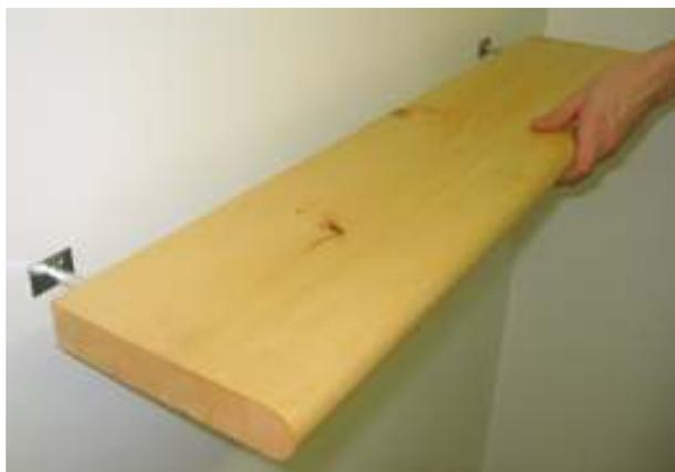
Cette conception permet de supporter jusqu'à 100lbs pour une tablette de 4" de profondeur et jusqu'à 50 lbs pour une tablette de 8" de profondeur grâce aux vis sans tête qui assure une tension entre les barres hexagonales et les plaques.
